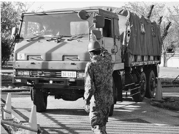
下車誘導により安全に狭路を通過させる隊員
