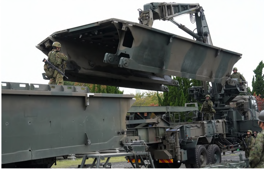
O7式機動支援橋架設の様子
