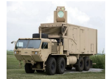
米陸軍の車両搭載型システム（HELMITT）
