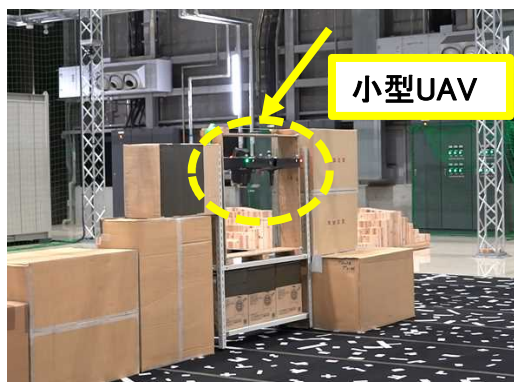
狭隘空間(窓枠を想定した枠)の通過状況
