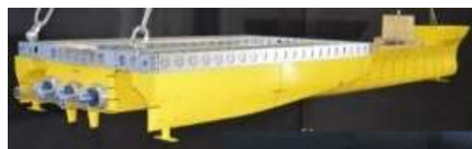
抵抗自航試験用模型
