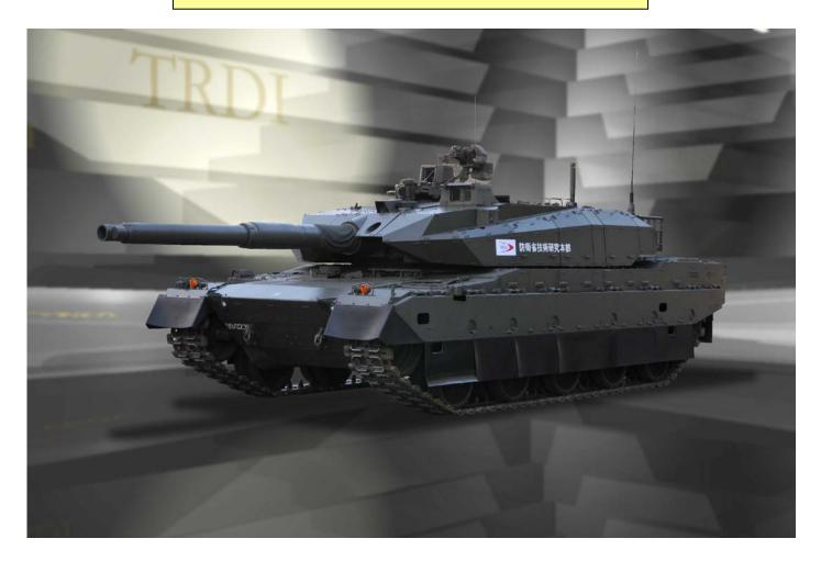
小型軽量化を図り、我が国の国土地形に適合した国産戦車である。 特に強化された機能として指揮・統制・通信性能及び機動性能があり、火力と機動力 を連携させた総合戦闘力の発揮を可能にしている。
