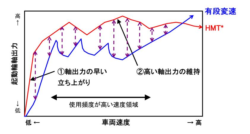
※ HMT: Hydro-Mechanical Transmission 油圧機械式無段階自動変速操向機
