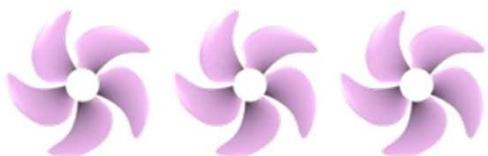
応力計測用プロペラ模型
