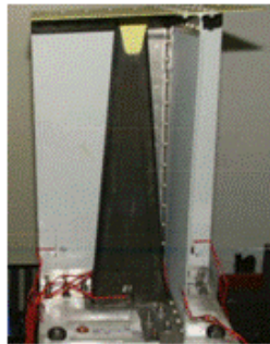
接合部構造 強度試験
