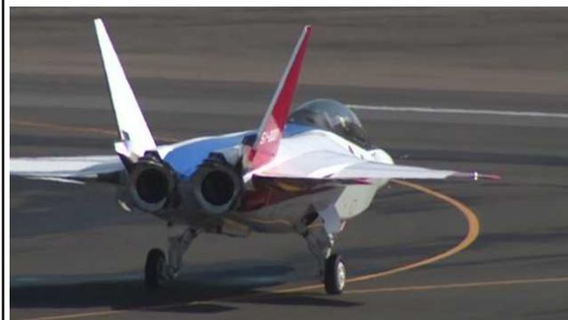
製造図に基づき製造した高運動ステルス機について各種関連試験及び全機地上試験を経て実施した社内飛行試験により、基本的耐空性を把握し引き続き防衛装備庁による飛行試験を実施しうる見通しを得た。
