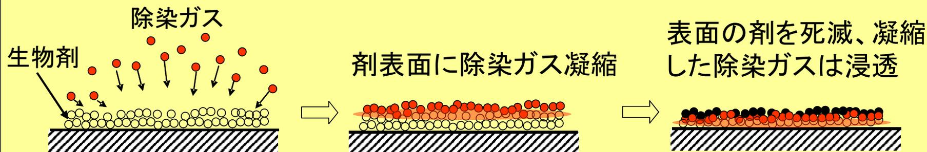
剤表面に均一に凝縮させるために**除染ガス均一化**が不可欠
