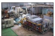
車両振動試験装置
