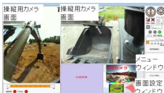
既存システム(CBRN対応遠隔操縦作業車両システム)における操作端末表示画面
