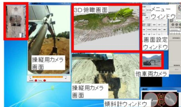
本研究試作成果を反映させた操作端末表示画面(例)
