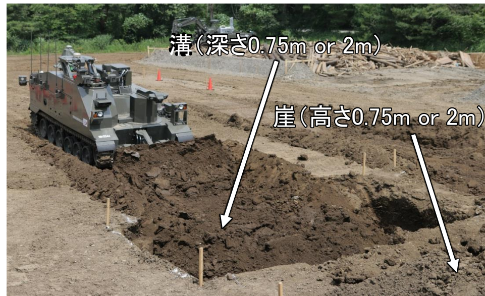
排土装置による溝・崖の通過
