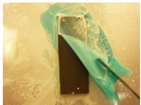
図2 剥離剤による放射性物質擬剤の 除染(プレコーティング)
