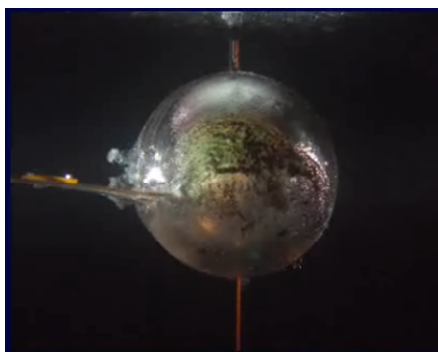
図1 金属細線爆発で発生したバブルの様子
