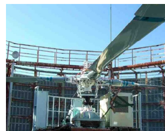
写真 ワール・タワー試験
