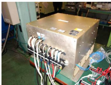
写真 高電圧電源システム
