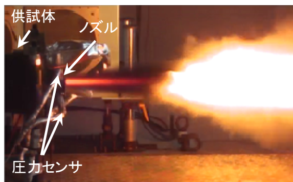
写真 燃焼試験状況
