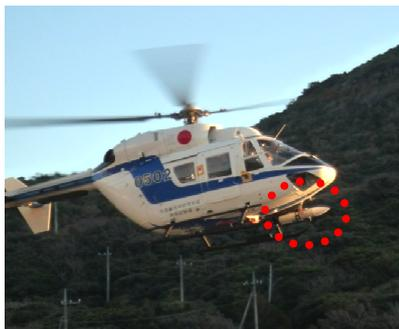
写真 2 試験母機への搭載状況
