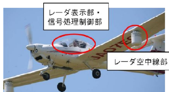
図2 自動衝突回避の飛行試験
