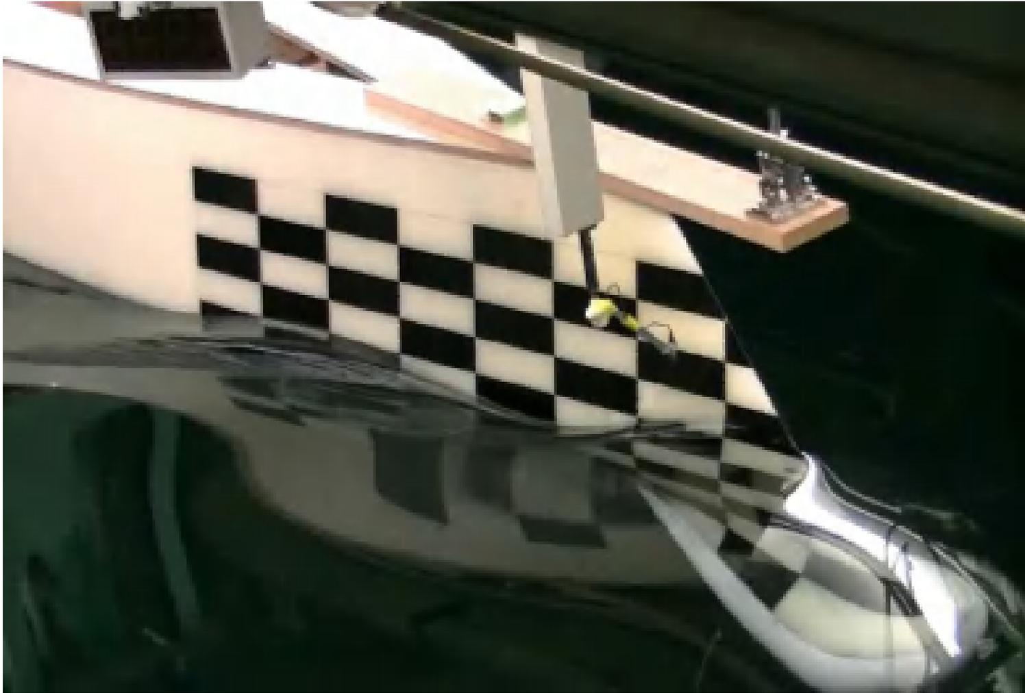
波高計による波浪中波高計測試験
