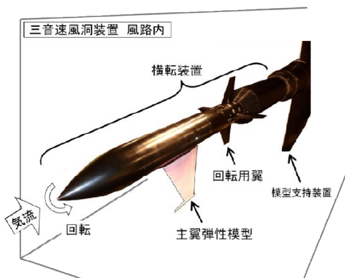
図1 空力弾性風洞試験の概要
