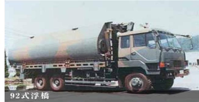
92式浮橋の専用運搬車
