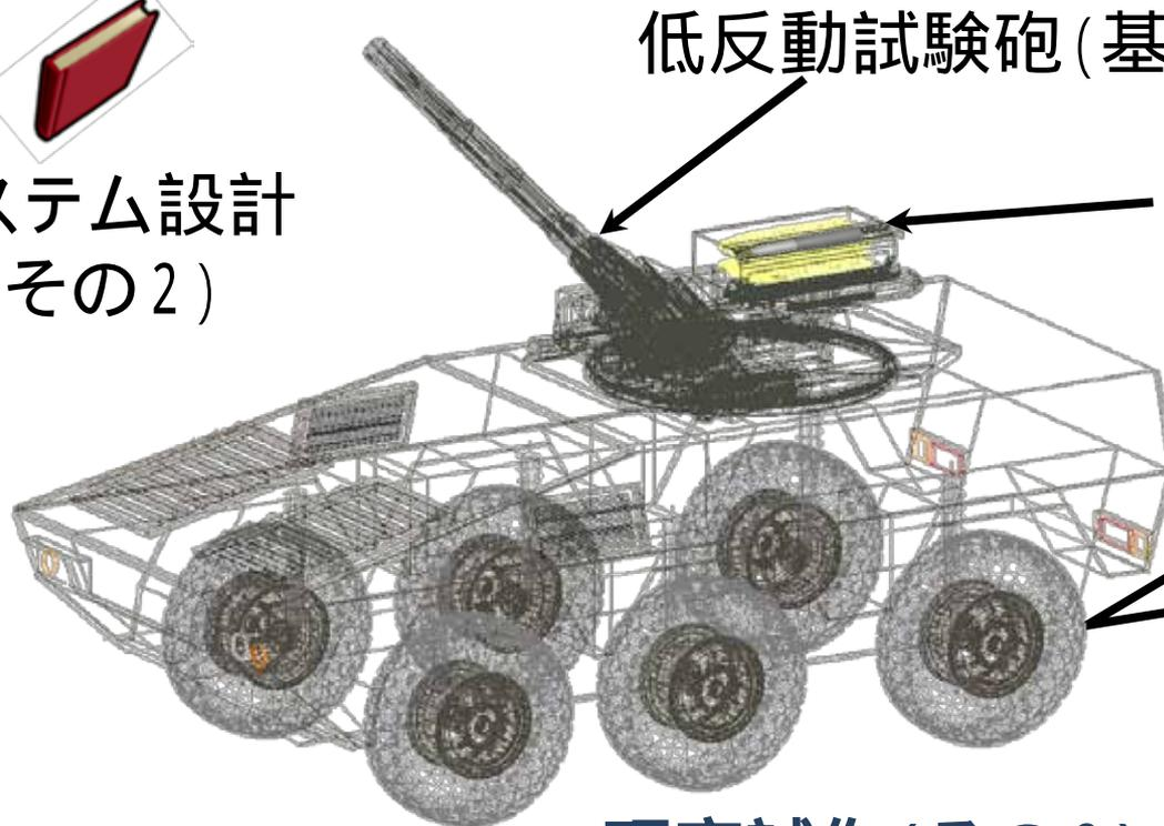
低反動試験砲(基本機構部)
