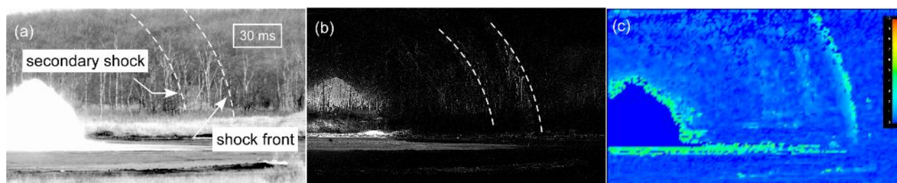
図1 BOS法による野外爆発で発生した衝撃波の可視化計測. a. 高速度ビデオ画像, b. 輝度差分法による処理, c. 相互相関関数による背景移動量抽出.
