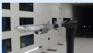
低速風洞試験：射出時の空力影響の確認 (KHI：岐阜工場（低速風洞）)
