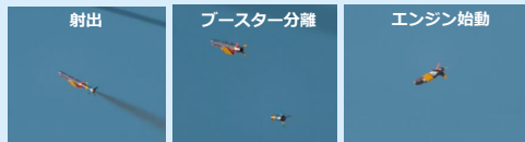
低速風洞試験：射出時の空力影響の確認 (KHI：岐阜工場（低速風洞）)
