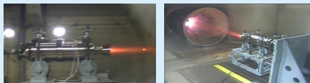
ブースター燃焼試験：推力・燃焼時間の確認 (日油：武豊工場)
