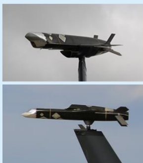
全機RCS試験：機体のRCSの確認 (新世代装備技術研究所 飯岡支所)
