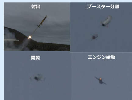
発射試験#1：機体のインテグレーション確認 (航空装備研究所新島支所)
