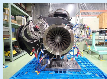
ファン試験：ファン要素のデータ取得 (KHI：明石工場)
