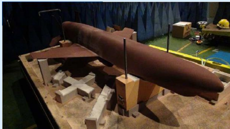
模型RCS試験：機体のRCSの確認 (KHI：岐阜工場（電波暗室）)
