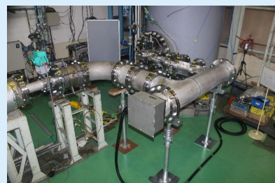
タービン試験：燃焼性能のデータ取得 (KHI：明石工場)
