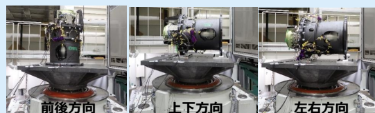
衝撃試験：衝撃負荷時のエンジン健全性確認 (IMV：大阪テストラボ)
