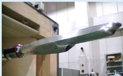
インテーク特性基礎試験：空力特性の確認 (KHI：岐阜工場（遷音速風洞）)
