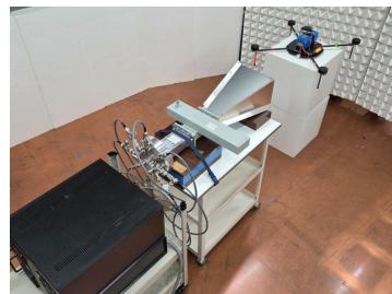
3kV/m @ 30cmの電界強度により、RTCA/DO-160などに規定されるHIRF(High-Intensity radiated Field)試験が可能
