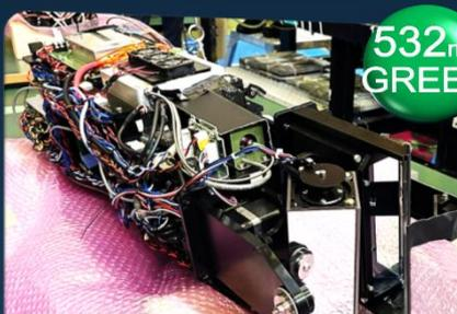
他の電磁波と比較して、可視光帯域のなかでも海中において伝搬性が担保される**532nm波長のパルスレーザー**（グリーンレーザー）を光源とする長距離レンジ+高分解能を有する**最新鋭の海中レーザー scanner の開発**を進めている。世界最高性能となる最大計測レンジ**60m(往復120m)**および最大水平分解能**8000画素以上**を実現することで、従来技術にない超高精細な海底可視化画像を生成する。
