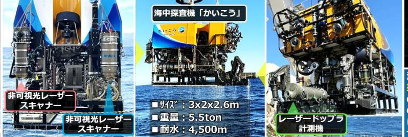
海中探査機「かいこう」に各レーザー試験機を搭載し、相模湾・初島東方の水深800-900mの海域において、**性能評価試験を実施**した。その結果、可視光・非可視光レーザー scanner により**精細な海底可視化画像が生成**され、レーザードップラ計測機により「かいこう」の移動速度に応じたドップラシフトが検出された。
