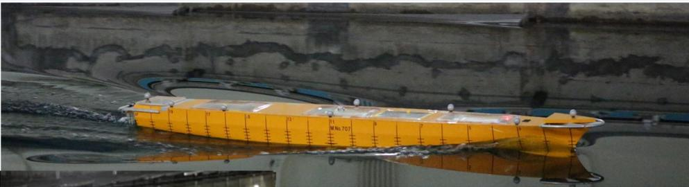
モーションキャプチャーによる計測により、**中高速域で約2%以上の速度上昇を確認。**
