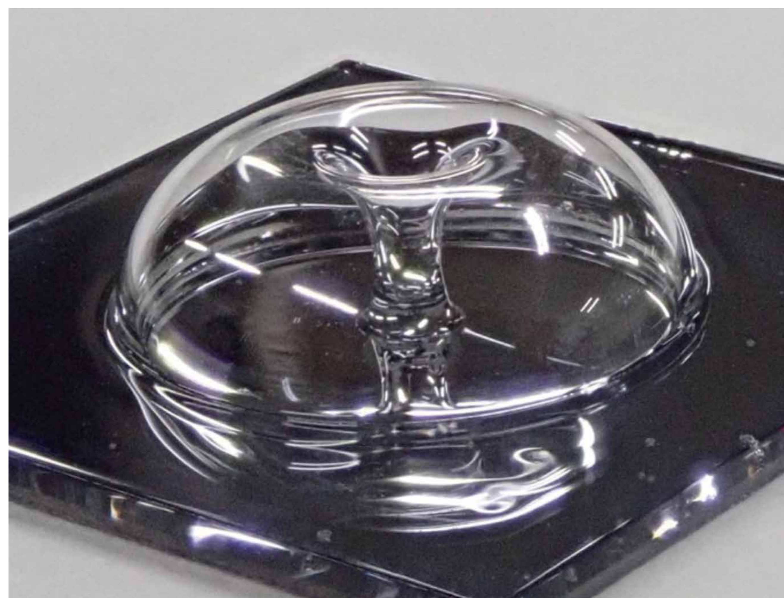
図2 高温真空層によるドーム形状試作 (テンパックスガラス)
