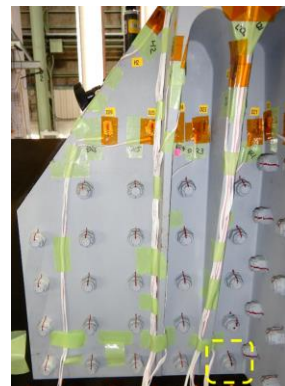
底板側ボルト孔の分解計測状況
