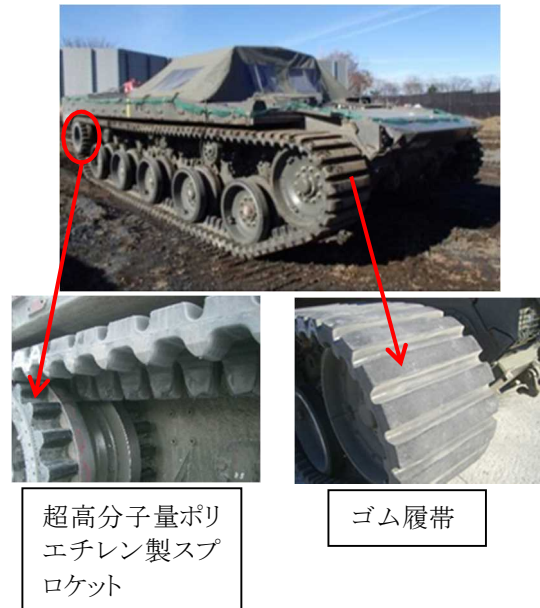
図 30t 級車両へのゴム履帯の適用状況
