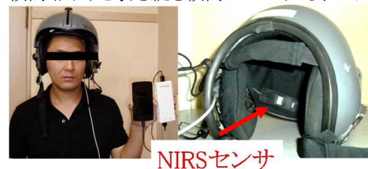
図2 ヘルメットとNIRSセンサの適合性
