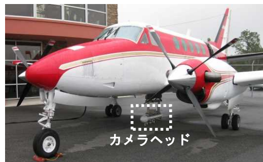
図2 画像ジャイロの試験状況(米国における画像ジャイロ搭載母機及びカメラヘッド)
