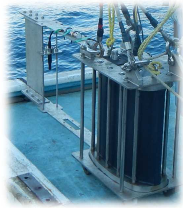
図1 フレクテンショナル型低周波えい航音源 (最大送波音圧約180dB@5kHz)
