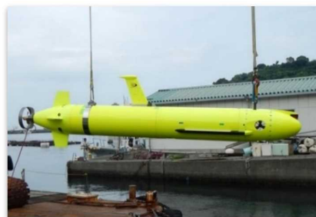
図2 USVと協調制御を行ったUUV
