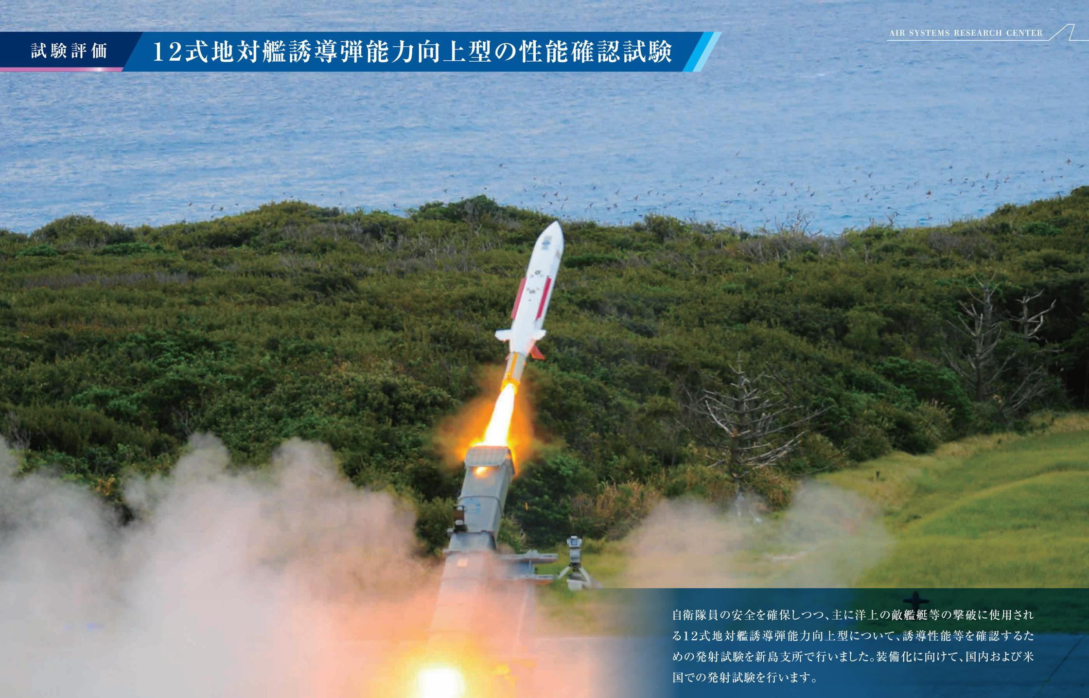
自衛隊員の安全を確保しつつ、主に洋上の敵艦艇等の撃破に使用される12式地对艦誘導弾能力向上型について、誘導性能等を確認するための発射試験を新島支所で行いました。装備化に向けて、国内および米国での発射試験を行います。
