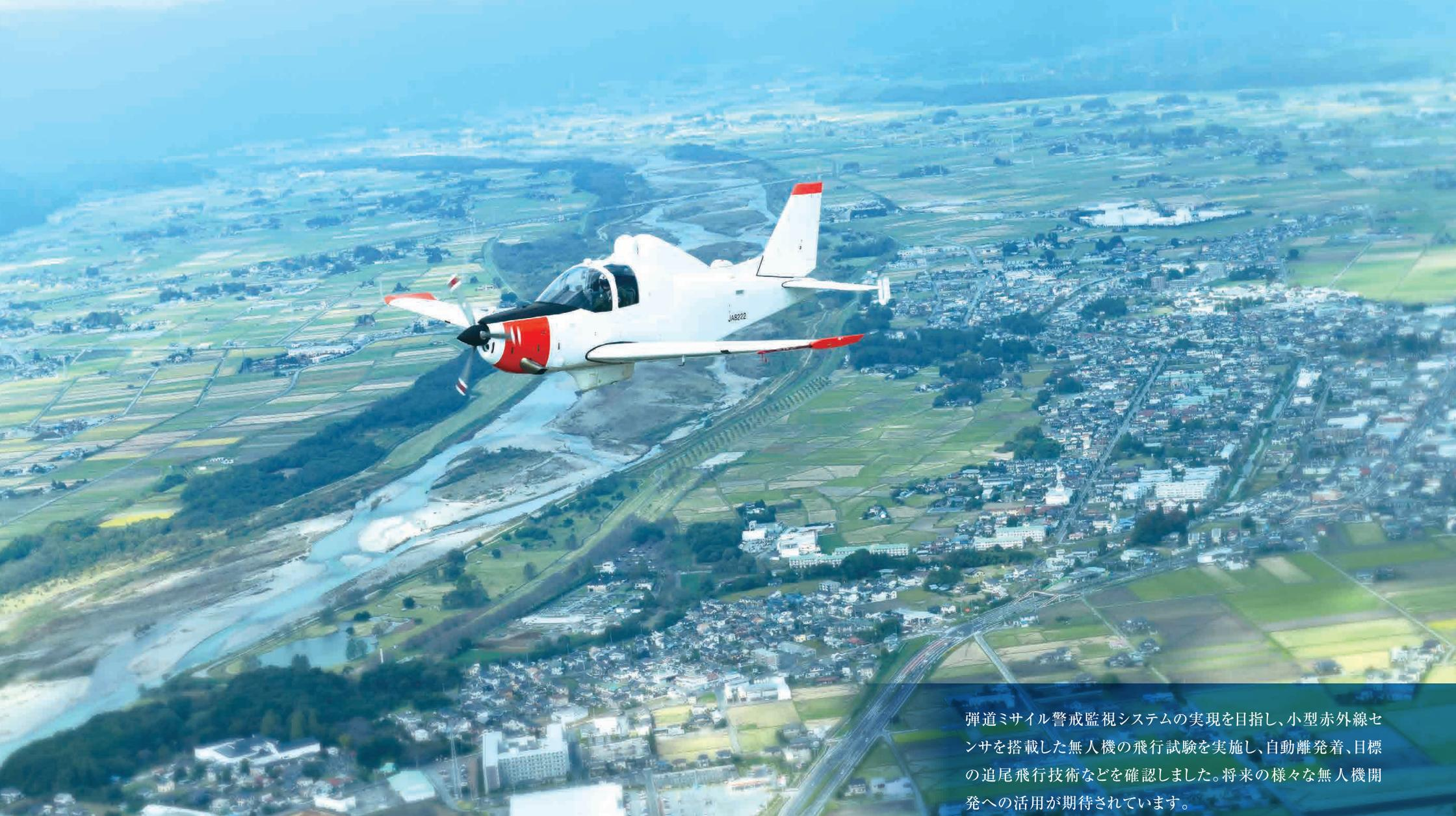
弾道ミサイル警戒監視システムの実現を目指し、小型赤外線センサを搭載した無人機の飛行試験を実施し、自動離発着、目標の追尾飛行技術などを確認しました。将来の様々な無人機開発への活用が期待されています。
