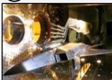
供試体(模型)を支持・駆動するためのスティング・ストラットに設置し、通風により各種データを取得する計測部です。超音速、超音速によって計測部カードの形状を変更します。試験中の模型周囲のシュリーレン映像も撮影可能です。
