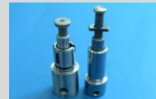
戦闘車両用エンジン燃料噴射ポンプ（高出力エンジンに使用するため民生エンジンより高精度の加工が求められる）
