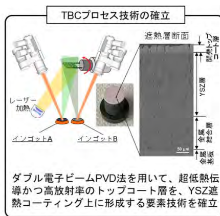
図 超低熱伝導・高放射率のトップコートを用いたTBCシステムの創生と性能実証
