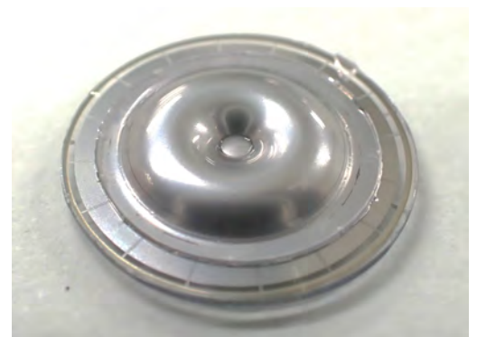
図3 高温真空炉による共振子試作
