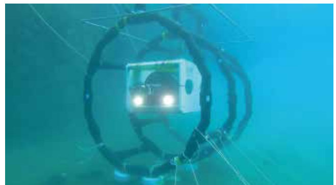
図2 実海域試験の様子 (海中に設置した送電コイルの中に受電コイル搭載のAUVを進入させ、ワイヤレス給電を実証)
