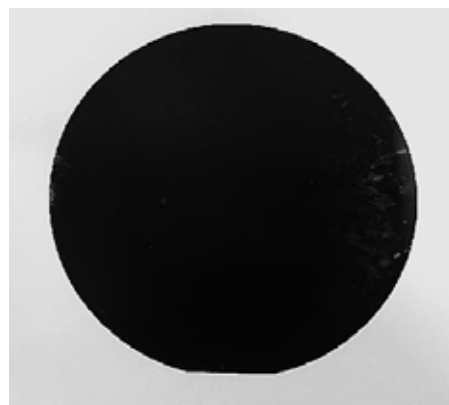
図2 直径100mmのサファイア基板上に単層グラフェンを繰り返し自動積層して形成した104層の多層グラフェン
