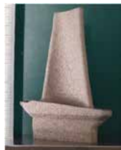
図1 Mo合金のタービン翼積層造形プロセス
