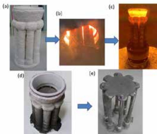
図1 (a)一方向凝固用鑄型と(b)~(e)一方向凝固炉を用いた鑄ぐるみコーティングプロセス
