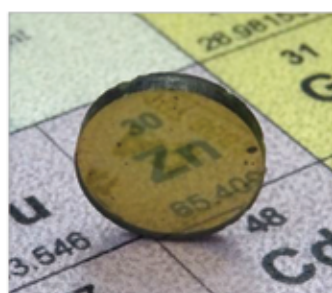
図 高圧力通電焼結法で得られたZnS(左)、硬度特性と閃亜鉛型→ウルツ鉱型の相変態挙動焼結温度の依存性(中央)及び高圧通電焼結されたZnSのTEM像(右)
