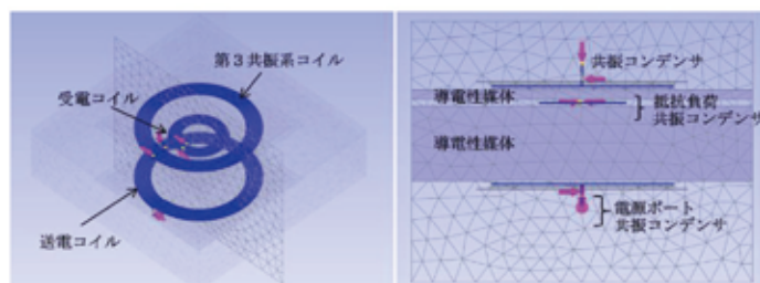
図2 第3共振系のモデル(左:斜視図、右:断面図)
