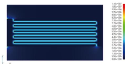
図1 新しい誘電体を含む渦電流解析積層コンデンサの解析例(電界分布)
