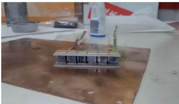
図1 ユニレグ型Mg<sup>2</sup>Si熱電池モジュール
