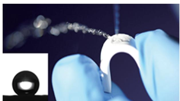
図2 バブルコーティングの厚膜化により、機械的ダメージに対しても影響を受けない超撥水材料
