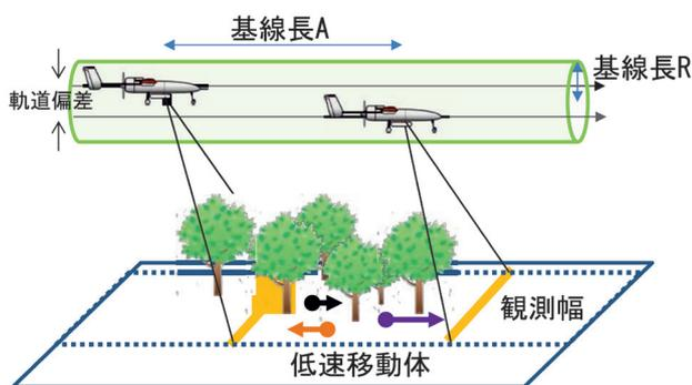
図 リピートパスINSAR概念図（上）と実験結果（右）
