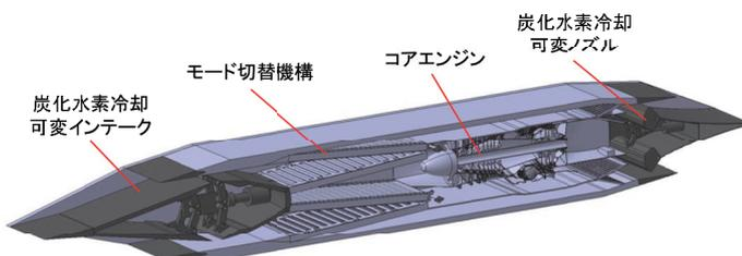
図1 極超音速複合サイクルエンジン
