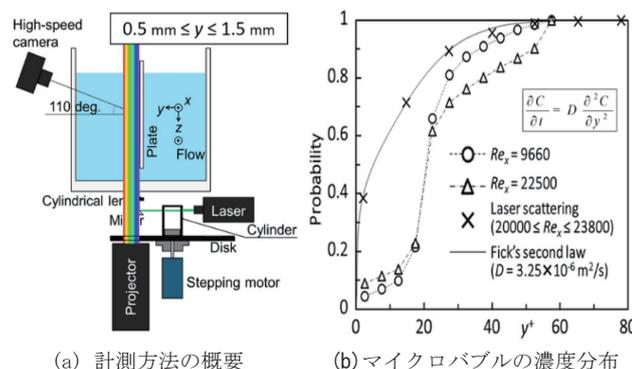
図2 クーロン力が顕在化するマイクロバブルクラウドの発生位置の計測
