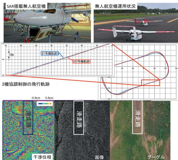
大樹町実験におけるリピートパス干渉実験解析事例(1機のUAVの繰り返し干渉)2016/11/20
