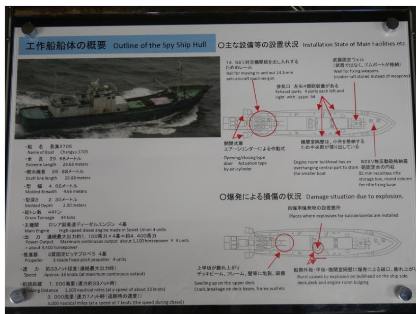
図3. 2-26 工作船舶体の概要（海上保安庁展示館に掲示）
