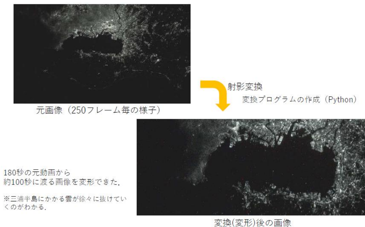
図 3.3-9 ISS 撮影画像に対し射影変換を行った効果
