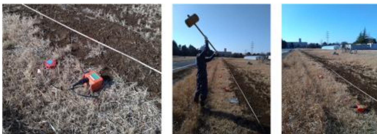
図1.2 左：微動計設置状況 中央：かけやによる起振状況 右：常時微動計測状況
