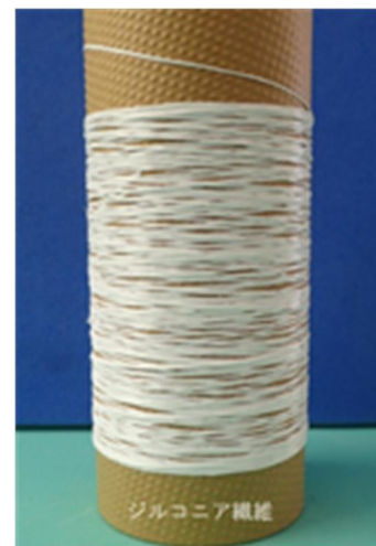
図18 160Hノズルを用いた紡糸風景と得られた \geq 200\text{tex} （100m/ボビン）の繊維束
