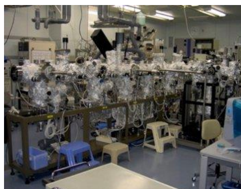
図(1.A)-1. 複合型分子線エピタキシー成長・表面構造評価装置
