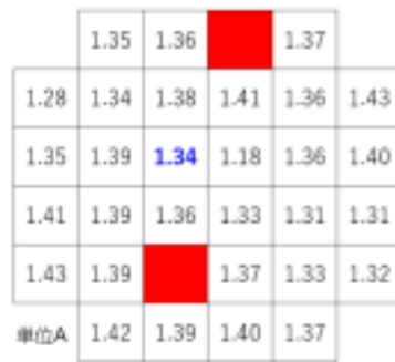
図 3-(4)-16 (a) ドレイン電流の 4 インチウエハ内分布
