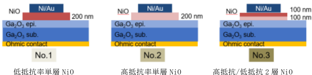
図 3-(3)-6 ヘテロ p-NiO/Ga 2 O 3 ダイオードの構造断面図
