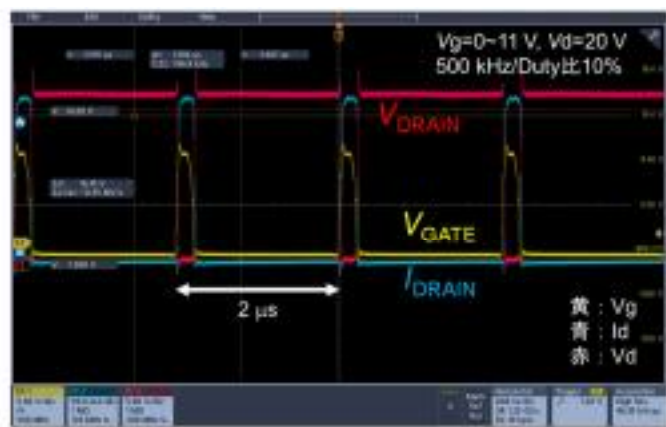
図 3-(5)-2 500 kHz 動作スイッチング波形
