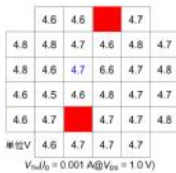
図 3-(4)-15 (a) I_D - V_{GS} 特性 (b) V_{TH} 分布 (1st scan 降圧) (c) V_{TH} の累積確率分布
