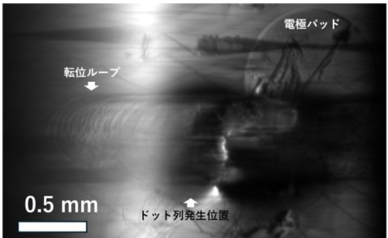
図 3-(6)-35 破壊後の X 線トポグラフィ観察
