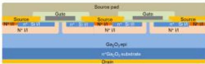
図 3-(4)-9 マルチセル D-MOSFET の断面構造図
